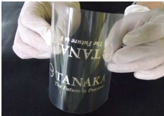
今回販売開始する銀インクを使い、フレキソ印刷法で作成した電子回路
