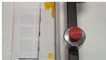
スーパーナップ法による金属配線の印刷製造工程の一部 (左) とフレキシブル基板 (右)
