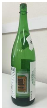
写真: 印刷できる商用 IC カード規格スピードの温度センサつき高速デジタル回路(左)と、温度センシング機能を搭載した電子タグの利用例(中、右)
