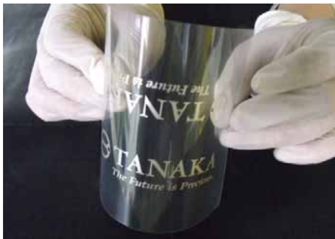
使用此次開始銷售之銀墨水，並以柔版印刷法製成之電子電路
