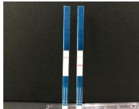
검사 시의 사용 예 (왼쪽이 음성, 오른쪽이 양성 반응을 보이고 있습니다. 바이러스를 검출하면 두 개의 선이 나타납니다.)
