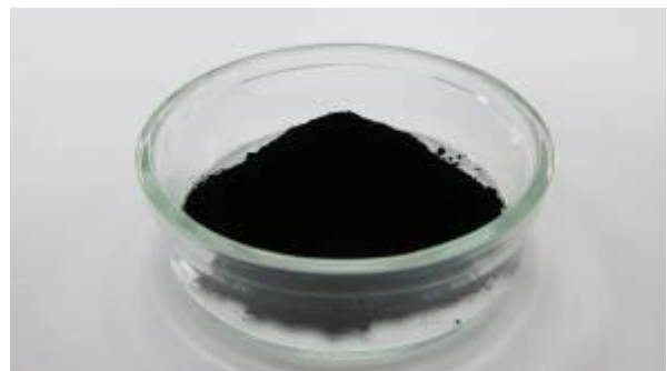
<出荷量世界一を誇る、田中貴金属工業のPEFC用電極触媒>
