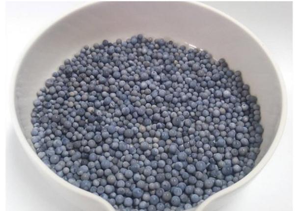
開発した粒状疎水性白金触媒（粒径3mm）
