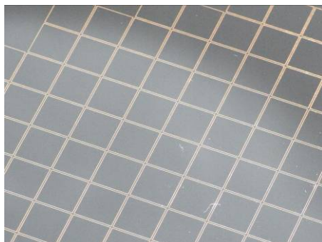
8インチのシリコンウエハ基板上に印刷した「AuRoFUSE™」の封止枠外観(200マイクロメートル幅)
