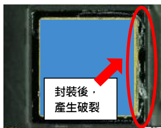
【目前的石英玻璃金錫封裝】 （金錫封裝後破裂的石英玻璃）
